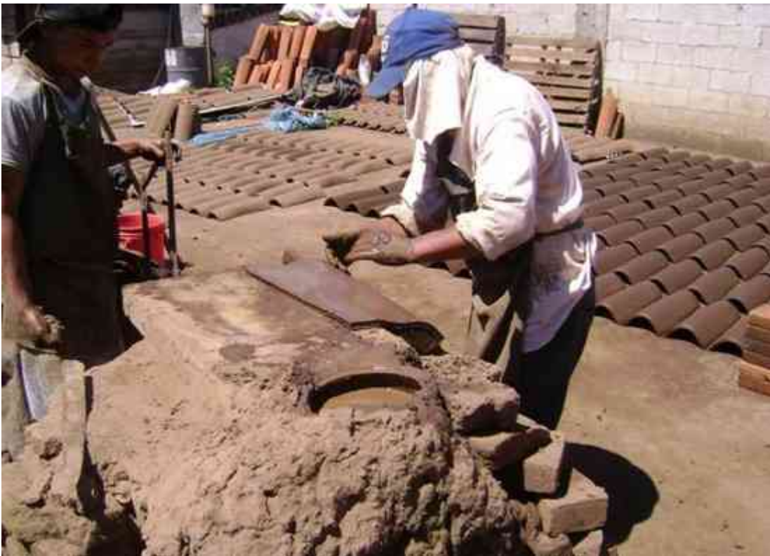
Imagen LXXVI: Elaboración de la teja. Fuente: http://vignette1.wikia.nocookie.net/guatemala/images/d/da/Imagen2.jpg/revision/latest?cb=20081108013447&path-prefix=es . (Último acceso: 21/05/15)
