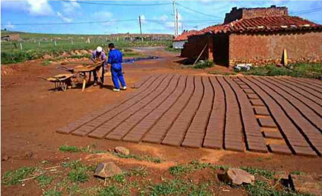
Imagen LXXVII: Elaboración de la baldosa. Fuente: http://www.elrincondeltrotamundos.com/wp-content/uploads/2012/01/Sin-t%C3%ADtulo-39.jpg . (Último acceso: 21/05/15)
