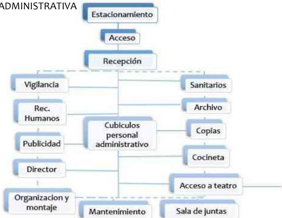
Figura 26. Diagrama de funcionamiento, realizado mediante el análisis de casos análogos.
