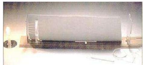
Banco óptico metálico: dispone de todos los elementos necesarios para llevar a cabo diferentes demostraciones de óptica. Consiste en un riel de metal extruido de 1 m. de longitud.<sup>49</sup>
