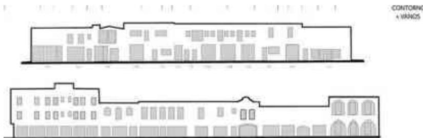
Ilustración 24 Relación de vanos y macizos en fachadas. Donde se observan todos los vanos que se tienen en la fachada sur y norte de la calle.
