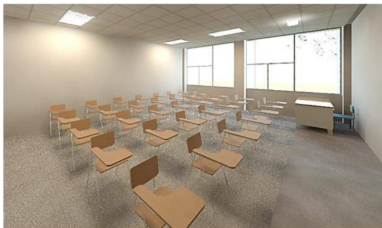
Piso en tono gris en los salones. Plafón de 600 x 600 mm terminado de yeso Imagen 281 y 282. Detalles
