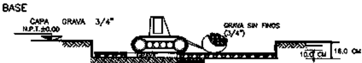
FIG. 3. COLOCACIÓN DE UNA CAPA DE GRAVA 3/4" SIN FINOS
