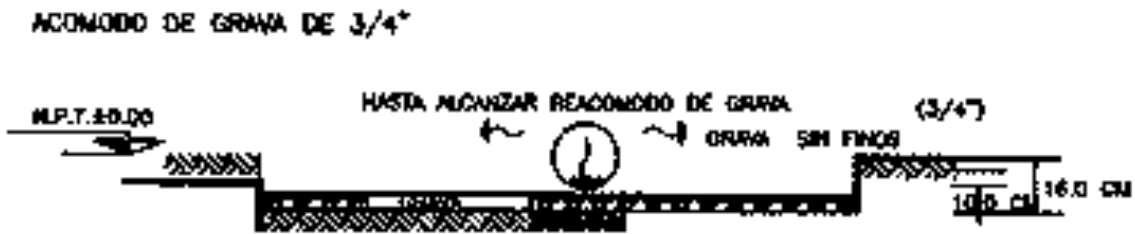
FIG. 4. COMPACTACIÓN DE LA CAPA DE GRAVA \frac{3}{4} " SIN FINOS POR MEDIOS MECÁNICOS FUENTE: http://www.concretoecologico.com.mx/sistemas.html FECHA: 12/JUL/15
