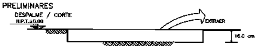
FIG. 1 OBRAS PRELIMINARES PARA COLOCACIÓN DE ECOCRETO
