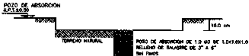
FIG. 2. CONSTRUCCIÓN DE POZO DE ABSORCION DE 1 M3 APROX CON RELLENO DE BALASTRE DE 3" A 6" SIN FINOS
