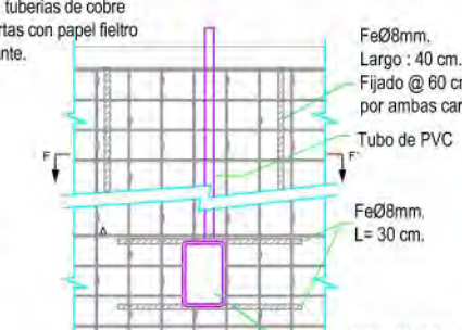
INSTALACIÓN ELECTRICA EN PANELES
