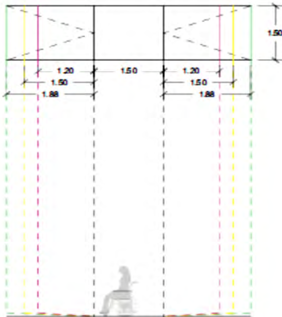
5. Rampa para cruce a la mitad de una cuadra con banquetas reducidas. El sendero baja completamente y después sube al mismo nivel, esto ocurre porque no se así no se ve afectada la circulación a través del sendero
