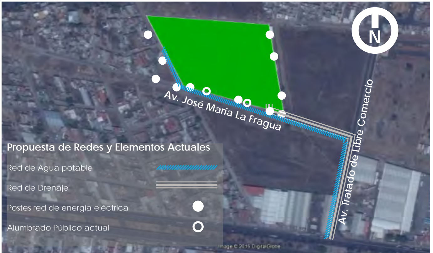
Gráfico 18. Localización de la red general de agua potable, alcantarillado y energía eléctrica.
