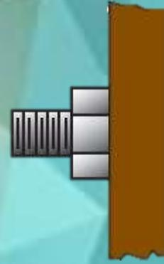
Imagen 40. Ejemplo de una proyección peligrosa que se extiende más de 2 roscas detrás de la tuerca y forma un peligro de empalamiento/laceración y puede también constituir un peligro de enredo. Fuente: Manual de seguridad para parques infantiles públicos.
