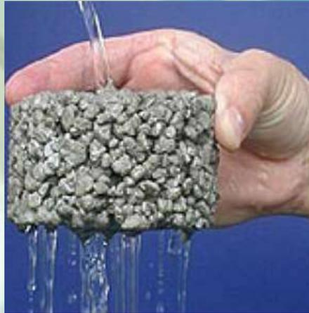
Imagen 62. En la imagen se muestra la permeabilidad del ecocreto.
