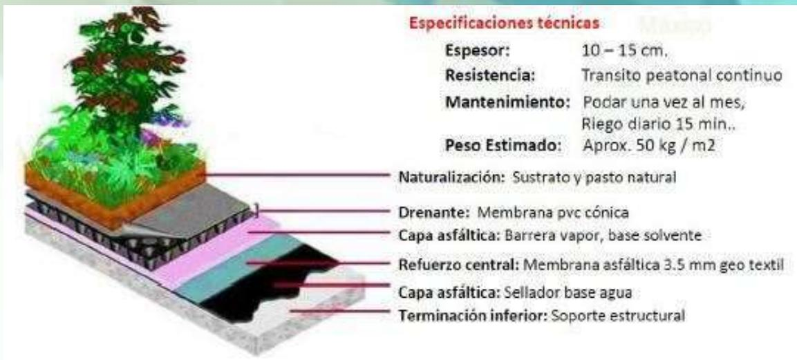
Imagen 49. Especificaciones técnicas y elementos que conforman una azotea verde.
