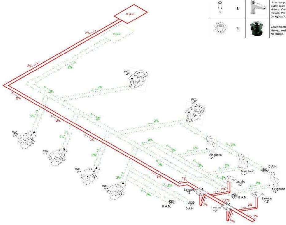
Isométrico de núcleo sanitario planta baja
