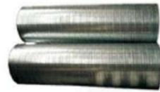
Ducto circular corrugado de lámina galvanizada marca dumont, de 20" de diámetro, calibre 24 (0.56 mm) para ramaje principal y de 14" de diámetro, calibre 26 (0.49 mm) para ramaje secundario extracción de aire.
