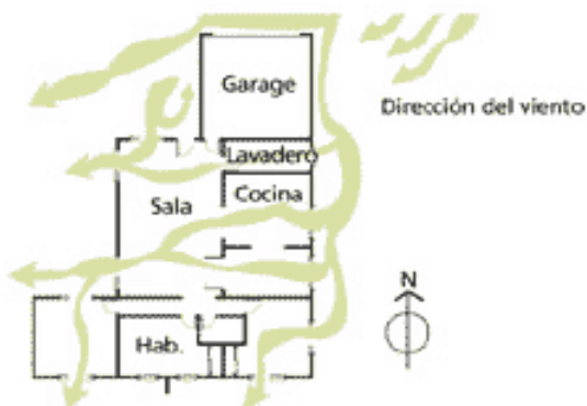
Fig. 5.31 Funcionamiento en planta de ventilación cruzada. Tomada de http://www.fau.ucv.ve/idec/racionalidad/Paginas/Manualambiente.html . Octubre 2015
