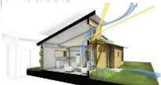
Fig. 3.11 Diagrama de Ventilación cruzada e incidencia solar. Tomada de http://www.mundohvacr.com.mx/mundo/2014/11/tecnicas-bioclimaticas-en-arquitectura/ Septiembre 2015
