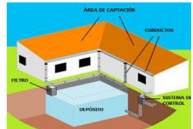
Fig. 3.18 Sistema de captación pluvial. Tomada de http://www.sitiosolar.com/los-sistemas-de-recoleccion-de-agua-de-lluvia/ Septiembre 2015
