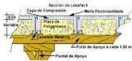
Fig. 5.15. Partes de una losa reticular en corte.. Tomada de http://pirhua.udep.edu.pe/bitstream/handle/123456789/1423/ICI_087.pdf?sequence=1 . Octubre2015
