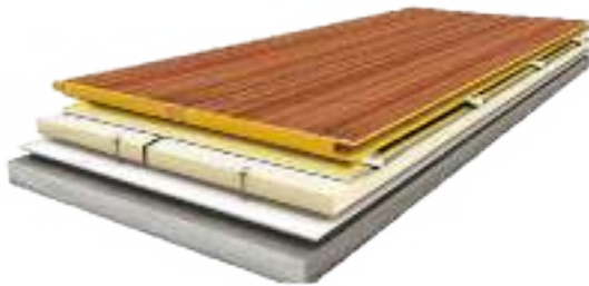
Fig. 5.23 Diagrama de instalación de piso de madera o laminado, con aislante acústico. Tomada de http://www.solucionesespeciales.net/Index/Noticias/02Noticias/374124-Que-son-los-pavimentos-flotantes.aspx . Octubre 2015
