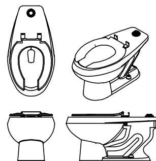
Taza para Fluxómetro Nao, Trampa Expuesta, 4.8 l MODELO: TZF-1 Marca Helvex CSI. 22 42 13.13
