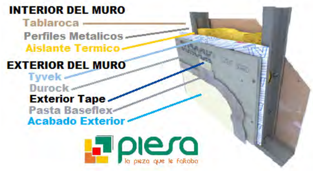
Fig 1.72 Durock corte del material por capas, disponible en http://tablarocaguadalajara.com/precio/tyvek-guadalajara-dupont/ Enero de 2016.
