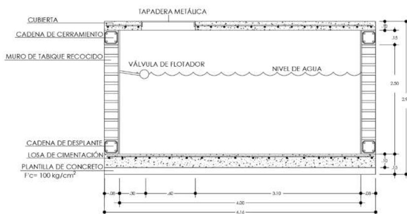
Figura 26. Dimensiones de la Cisterna para el Agua Potable
