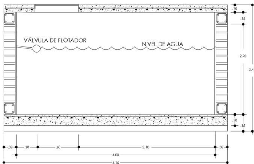
Figura 29. Cisterna para Captación de Precipitación Pluvial
