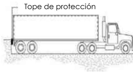
**Imagen 54:** Topes de protección, fuente: Manual KELLEY diseño de
