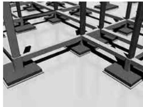
Fig. 91. Imagen de zapatas aisladas con columnas metálicas Fuente: datos obtenidos en google. . 10/12/2014
