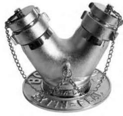
Toma siamesa de bronce cromada de 101x64x64mm. Marca FYR-FYTER. mod. 354. colocada a 1m sobre nivel de piso terminado N.P.T. Con leyenda "bomberos" al frente
