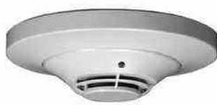
Detector de humo multicriterio, marca FireLite modelo AD355 se ajusta automáticamente al nivel de sensibilidad, combinación de fotoeléctrico y térmico, se ajusta al medio ambiente de manera automática.
