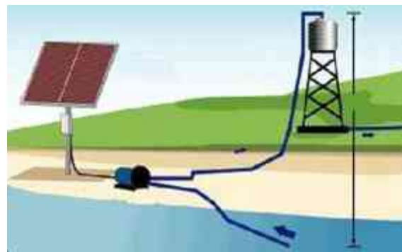
Imagen. Se muestra el funcionamiento de una bomba solar. Fuente: http://image.made-in-china.com/44f3j00uTvarmNqYQkW/Solar-Surface-Pump-Solar-DC-Pressure-Booster-Pump-System.jpg
