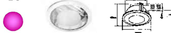
Spot tecno lite modelo YD-222/B nombre montero aplicación downlight material de la carcasa aluminio laminado blanco pantalla cristal base G24q3x2 tipo de lámpara fluorescente, tensión nominal 120-227 v consumo de potencia 10 w consumo de corriente 0.43-0.19 temperatura de color 41000k color de luz blanco frio horas de vida 10 000h.
