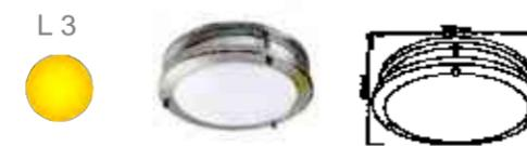
Lámpara tecnolite modelo FC-4030/3 nombre de la lámpara Base aplicación plafones fluorescentes terminado salmado base portalámpara C10q tipo de lámpara fluorescente tensión nominal 100-127 v, consumo de potencia 40w, frecuencia nominal 60hz consumo de corriente 0.40-0.31 A, horas de vida 10 000h
