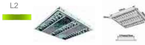
Lámpara tecnolite modelo LTL-3140/41 nombre de la lámpara Base aplicación oficina material carcasa lámina de acero terminado pintura color blanco pantalla bovestralumina tipo de lámpara 15 fluorescente de 14w, tensión nominal 120-277 v color de luz frío Ángulo de temperatura 80 temperatura de operación 10-40c fuente balastro electrónico distorsión armónica <math>\leq 10\%</math>
