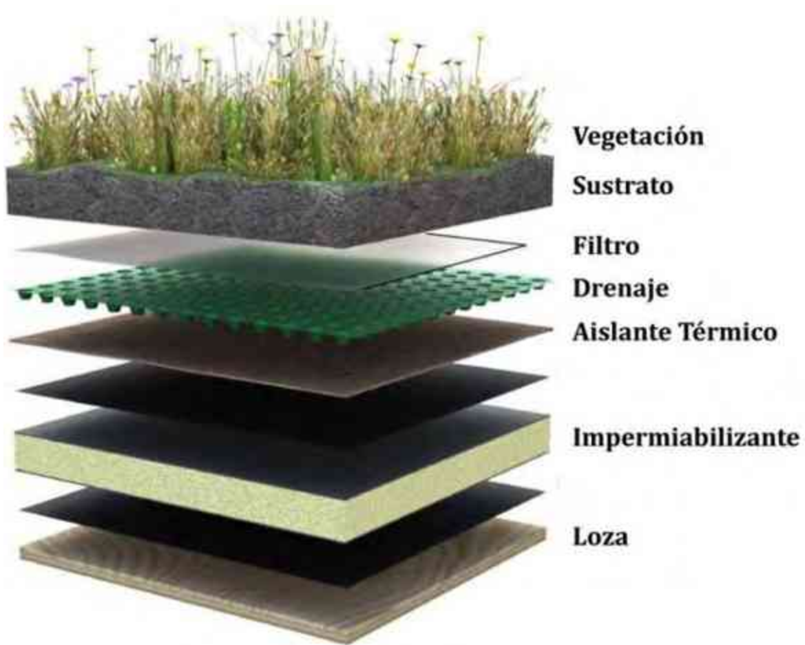
Ilustración 36. Corte del techo verde. Imagen tomada de Google.
