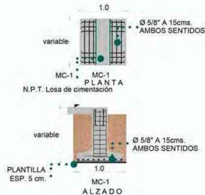
Detalle muro de contención
