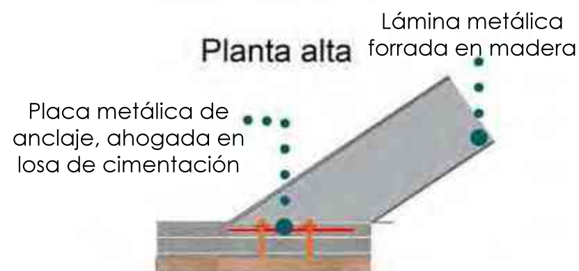
Anclaje a losa de cimentación S/E
