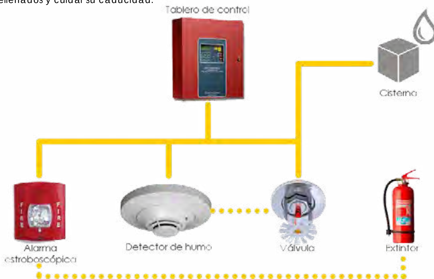
Figura 159. Sistema contra incendio, elaboración propia.
