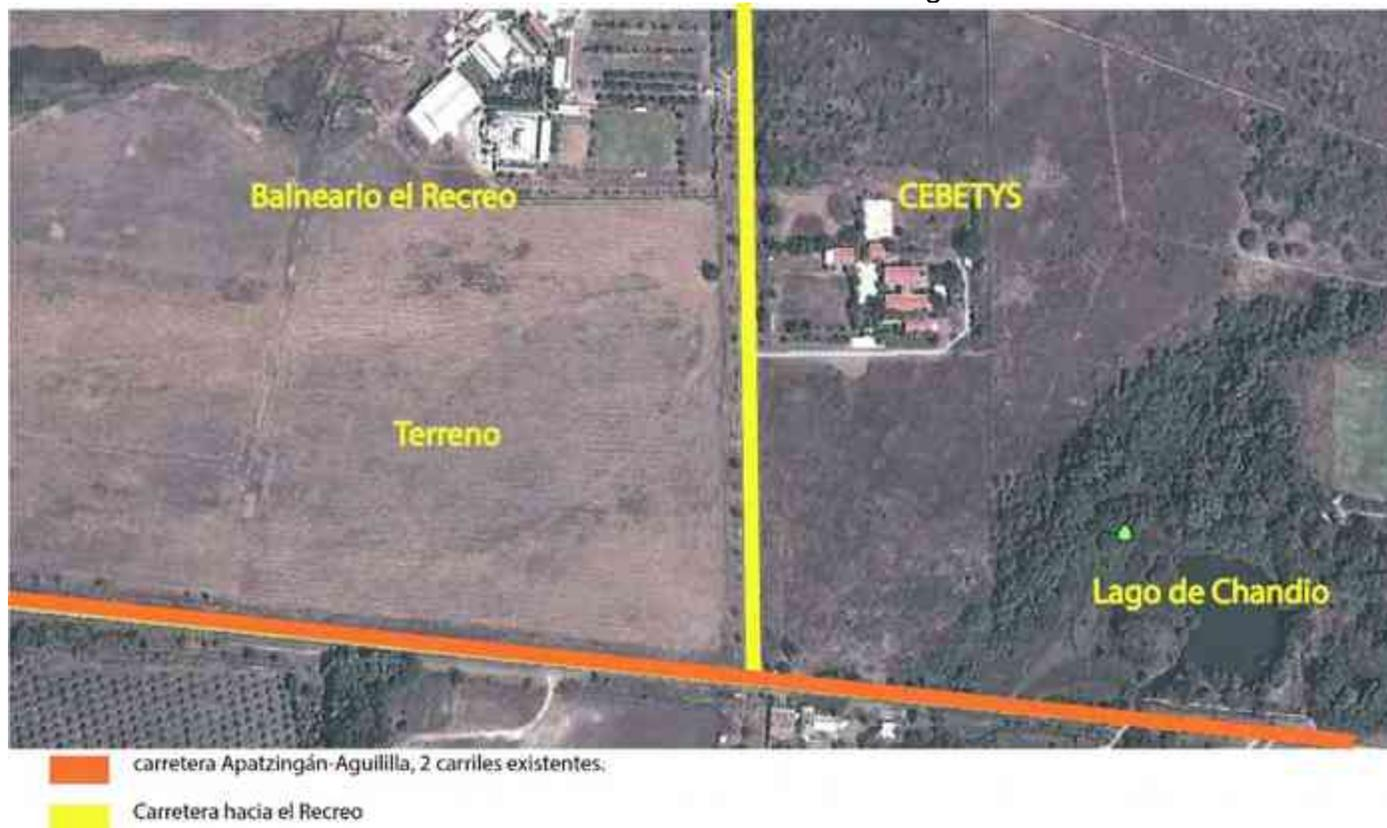
Las dos carreteras existentes están conformadas de una carpeta asfáltica y son de dos carriles, lo que nos da un ancho de aproximadamente 7.50 metros, estos dos carriles pueden ampliarse posteriormente a 4 o 6 carriles, debido a que existe una dimensión del centro de la vialidad al inicio del terreno de 25.00 metros.
