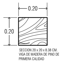
Viga V-4 ESC:1:15 Cotas: Mts.
