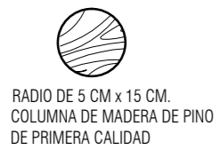
Columna C-1 ESC:1:10 Cotas: Mts.
