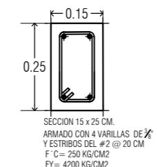
Trabe de Cimentación TC ESC:1:15 Cotas: Mts.
