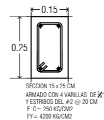
Trabe de Cimentación TC ESC:1:15 Cotas: Mts.
