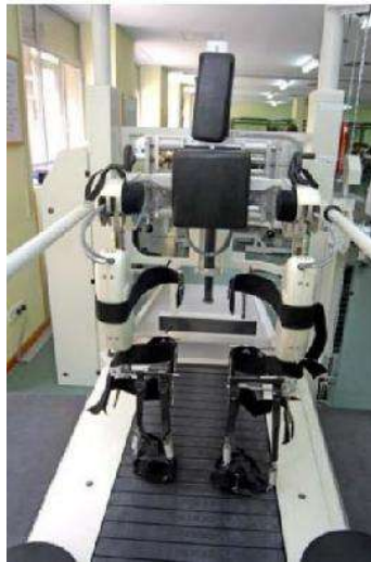
Ilustración 120 Tapiz rodante y prótesis. Fuente: Efectividad del entrenamiento de la marcha mediante el sistema lokomat en pacientes agudos con lesión medular incompleta.PDF, pág. 97 [13/03/2017].
