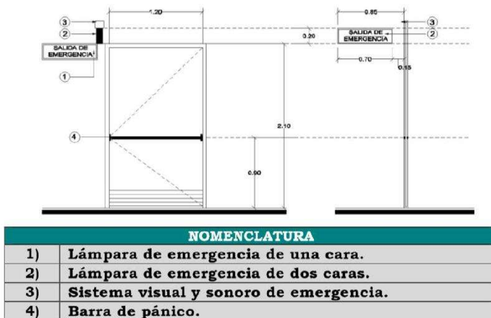
Figura No. 6.2.a. Salidas de emergencia.
