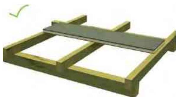
Imagen 35.- Instalación del panel sándwich – PanelSándwich.ORG
