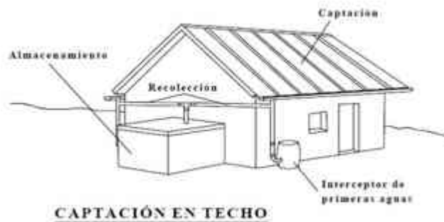
Ilustración 40/ captación de agua pluvial/ manual de ecotécnicas
