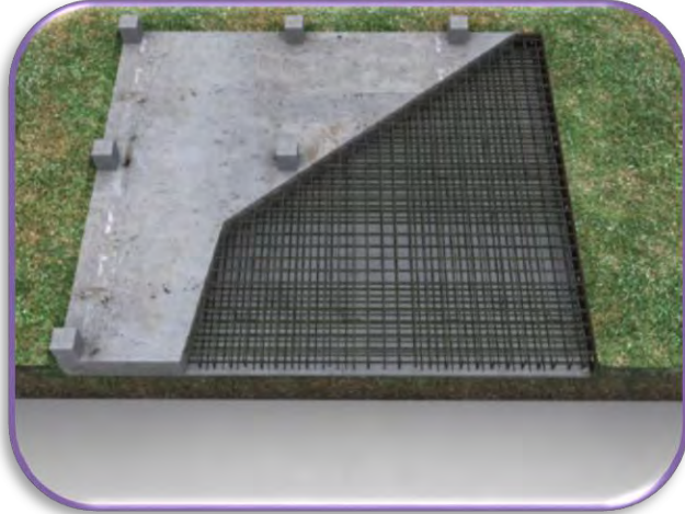
Ilustración 82 Ejemplo de losa de Cimentación
