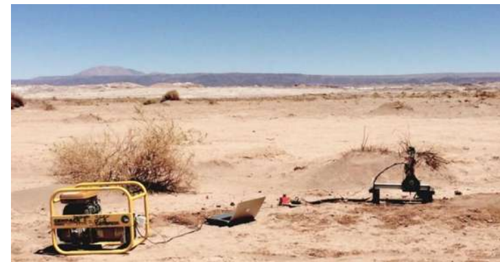
Imagen 22: SANDBOT, sistema móvil para la impresión 3D en arena Sitio web: http://sandbot.cl/web/ [12/08/2017]
