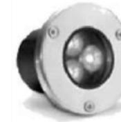
NYX LED, luminaria tamaño S, fijación empotrada en suelo, cubierta plana, difusor de policarbonato prismático plano, 3 W de potencia, 1N, con equipo electrónico. Luminaria Clase II. Sin precableado, tensión de alimentación 230 Vac/50 Hz. Acabado del aro SS (Acero Inoxidable).
