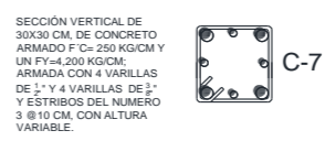
CASTILLO DE MURO DE CONTENCIÓN
