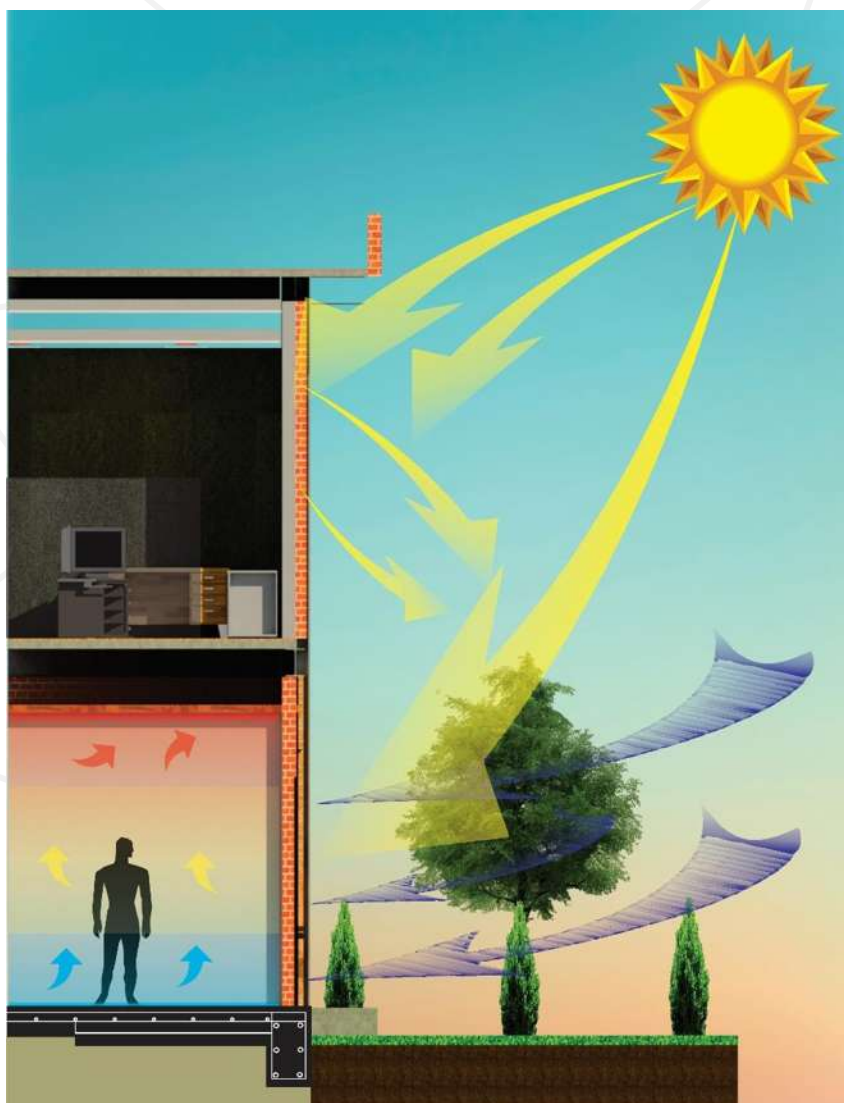
Imagen 22. Corte por fachada de cabinas con estrategias aplicadas, elaborada mediante el programa REVIT y editado en CorelDRAW. Elaboración propia.
