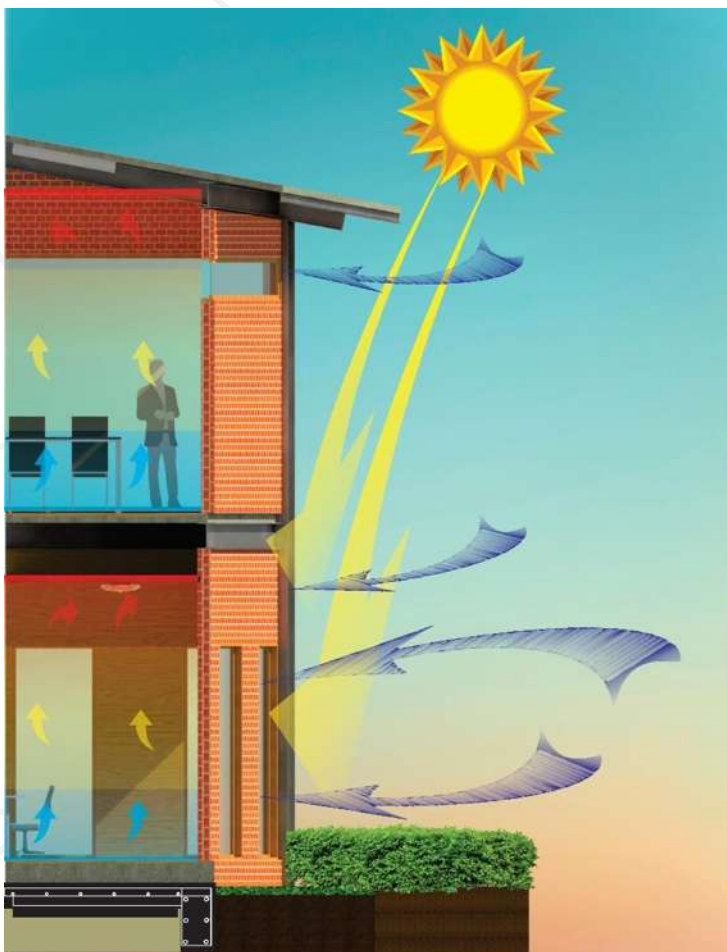
Imagen 24. Corte por fachada comedor y sala de juntas con estrategias aplicadas, elaborada mediante el programa REVIT y editado en CorelDRAW. Elaboración propia.
