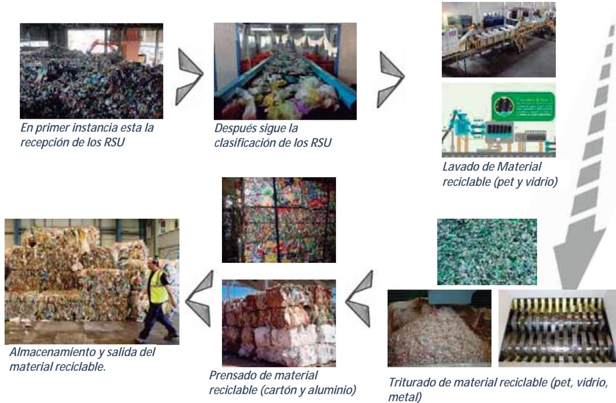
Imagen 107: línea de proceso de los RSU. Recuperada de navegador qoogle Chrome 05/01/18
