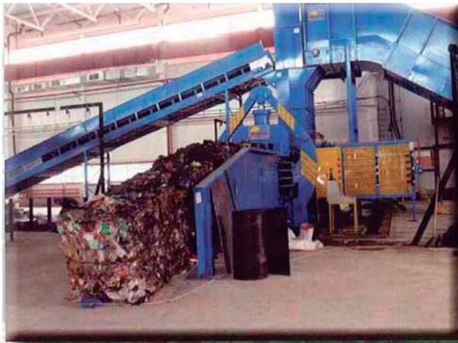
Imagen 80: Prensa para el rechazo de los RSU.
