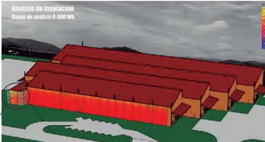
Imagen 43: estudio de insolación. Construida con ecotec análisis.
