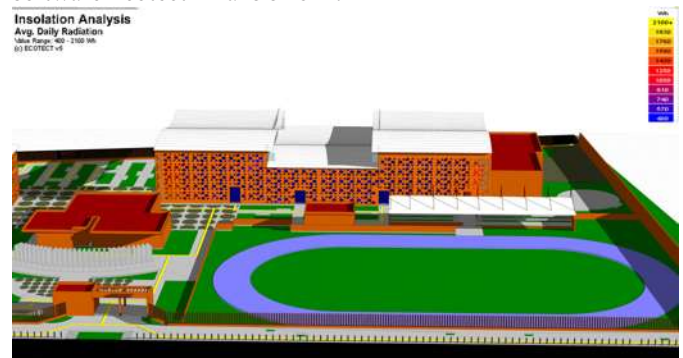
Grafica 5 Radiacion Total en fachada Sur con la piel, de Alberca Semi-olimpica; elaboracion propia mediante software Ecotect Analisis 2011.
