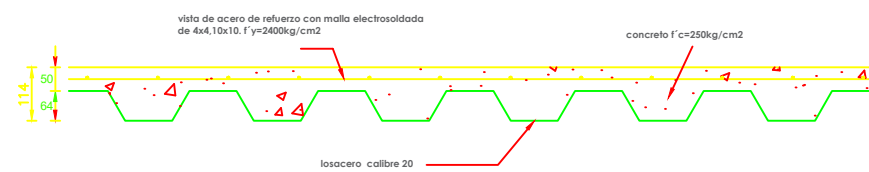
Sección losa de entrespiso
