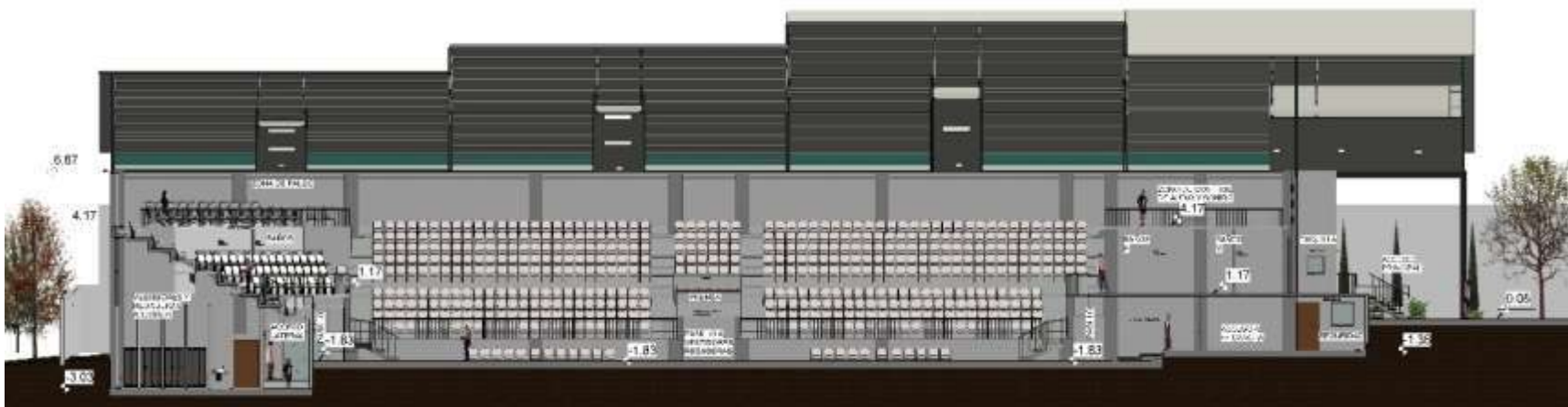
Imagen 60:: Visualización en corte longitudinal de uso de plataformas en diferentes niveles para aprovechar topografía. Render elaboración propia. 06/17/2018.
