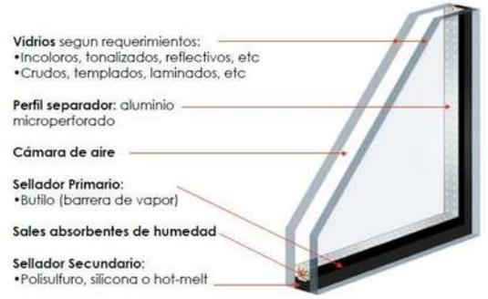
FIGURA 43 | Cristal doble para áreas de exhibición FUENTE I (CONSTRUMÁTICA, 2018)
