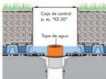
FIGURA 23 | Aljibe, del sistema de canales multidireccionales. FUENTE I (LIFE ON ZINCO ROOFS CUBIERTAS VERDES INTENSIVAS, 2018)
