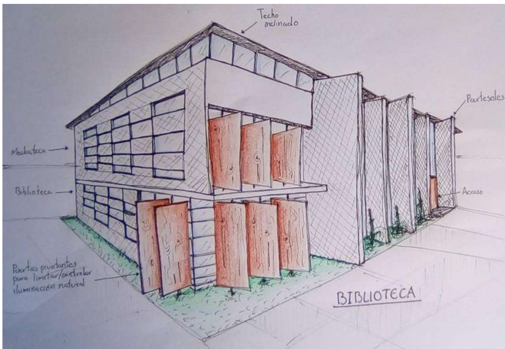
Imagen 58: Para tener vientos cruzados se colocan ventanas en la parte posterior y en la fachada principal. La mediateca es un espacio donde se usan una gran cantidad de sistemas y aparatos eléctricos que generan calor, para el enfriar el espacio, este se coloca en el segundo nivel con doble altura y techo inclinado para reducir el la temperatura. Quedando la fachada principal hacia el suroeste, se protege con muros partesol y una serie de puertas pivotantes para el control de la iluminación en el interior. Columnas de concreto soportan la estructura.
