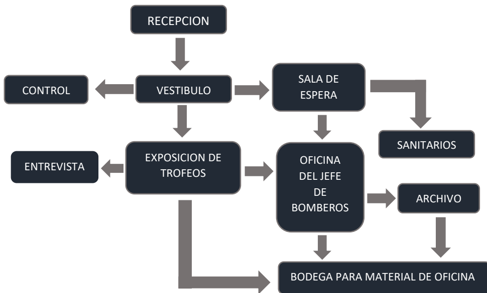
Imagen 60. Diagrama de funcionamiento del área de administración realizado por Edson Horacio León Herrejón. Diciembre del 2017
