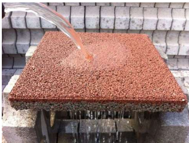
Ilustración 114 Material permeable Fuente: (Aconsa, 2019)
