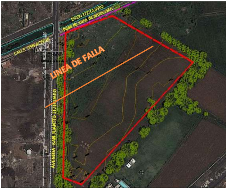
Ilustración 1 Ubicación del predio, sobre la Av. San Juanito itzicuaró, selección del terreno y trazando la línea de falla existente.
