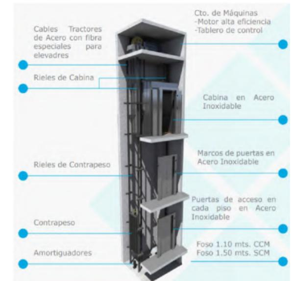
Ilustración 145. Isométrico del elevador. Imagen editada por el autor. Jun/2019
