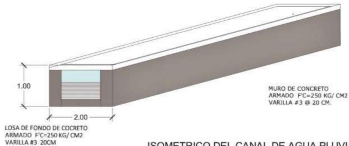
**ISOMETRICO DEL CANAL DE AGUA PLUVIAL**
