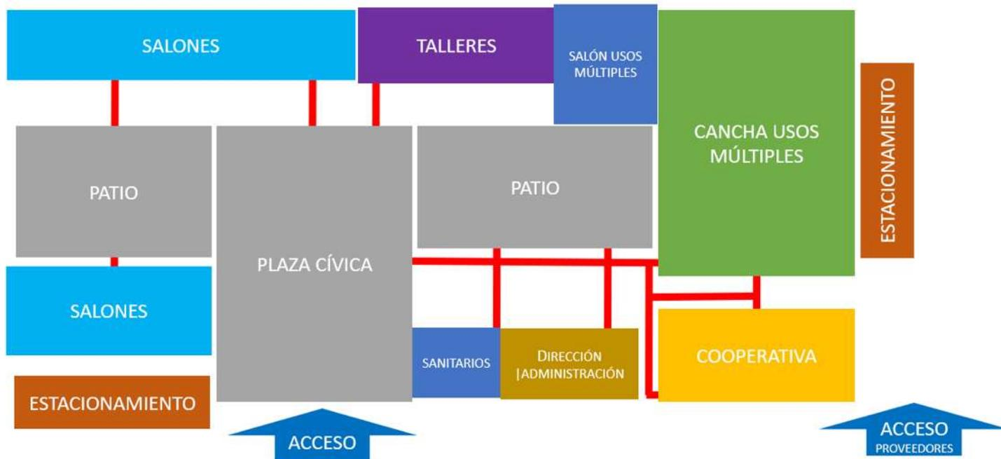
Figura 38 Diagrama de funcionamiento propuesto para la secundaria. Autor: PCAM
