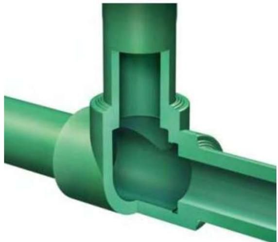
**Ejemplo de tubería de termofusión tuboplus**
