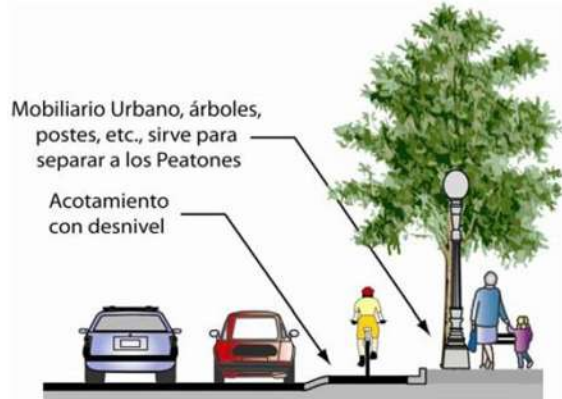
Imagen 47 Sección tipo ciclovía unidireccional compartida en arroyo. Lineamientos y estándares para vías peatonales y ciclovías para el área metropolitana de Guadalajara
