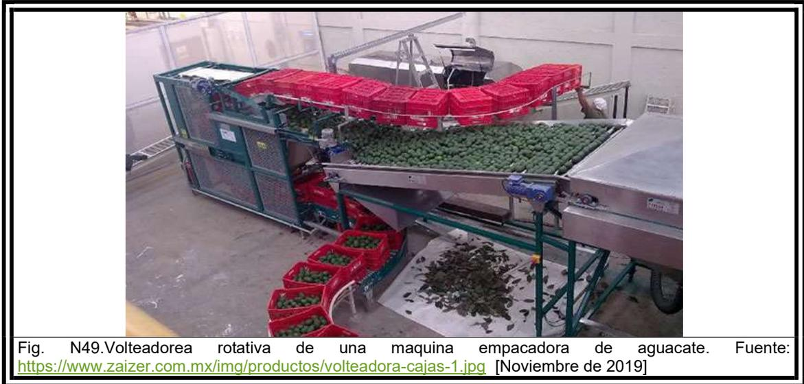
Fig. N49. Volteadora rotativa de una maquina empacadora de aguacate. Fuente: <https://www.zaizer.com.mx/img/productos/volteadora-cajas-1.jpg> [Noviembre de 2019]
