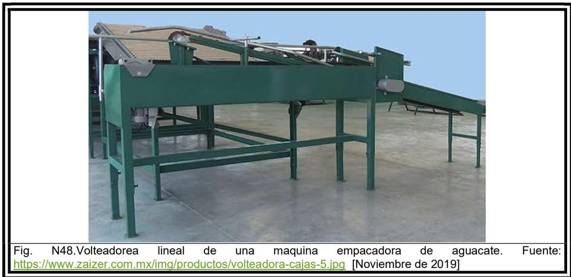
Fig. N48.Volteadora lineal de una maquina empacadora de aguacate. Fuente: <https://www.zaizer.com.mx/img/productos/volteadora-cajas-5.jpg> [Noviembre de 2019]
