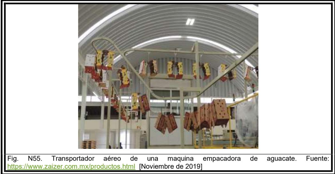
Fig. N55. Transportador aéreo de una maquina empacadora de aguacate. Fuente: <https://www.zaizer.com.mx/productos.html> [Noviembre de 2019]
