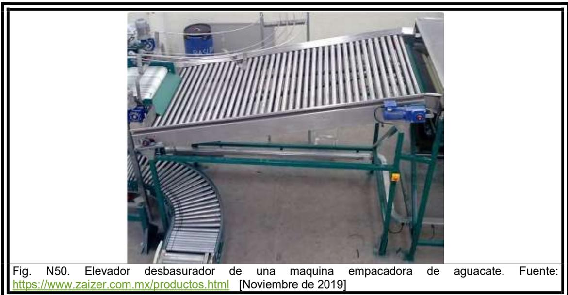
Fig. N50. Elevador desbasurador de una maquina empacadora de aguacate. Fuente: <https://www.zaizer.com.mx/productos.html> [Noviembre de 2019]
