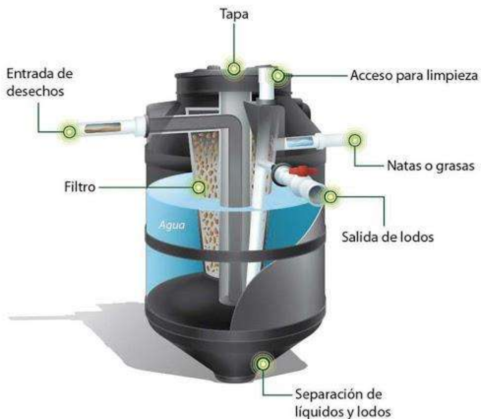
Imagen 2.3 Biodigestor y sus componentes.
