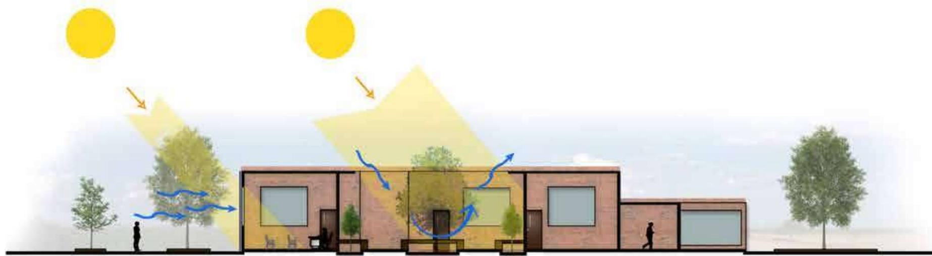
Flujo interior de vientos y radiación solar
