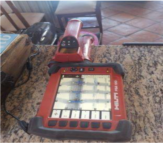
Imagen 115 Dispositivo Ferroskan PS300. Nota: Detector de localización de corrugados para hormigón, mediciones de profundidad y estimaciones de tamaño en análisis estructurales.
