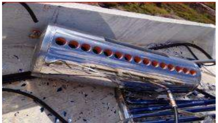
Imagen 20 Calentador solar dañado. Nota: El área de edificación solicitaba la revisión de los materiales y/o accesorios de las viviendas ya entregadas y que por algún motivo se dañaban y los propietarios solicitaban el cambio del producto.
